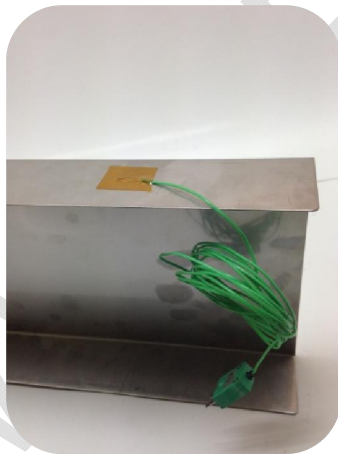
ภาพที่ 8 สายวัดอุณหภูมิผิวชิ้นงาน (Surface Thermocouple) ซ้าย Clamp Surface ขวา Kapton High Temp. Max 300°C Tape 33m Length (3,500 บาท) ไม่รวมในชุดอุปกรณ์
