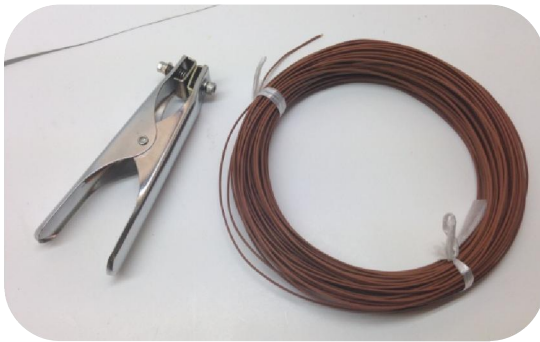
ภาพที่ 8 สายวัดอุณหภูมิผิวชิ้นงาน (Surface Thermocouple) ซ้าย Clamp Surface ขวา Kapton High Temp. Max 300°C Tape 33m Length (3,500 บาท) ไม่รวมในชุดอุปกรณ์
